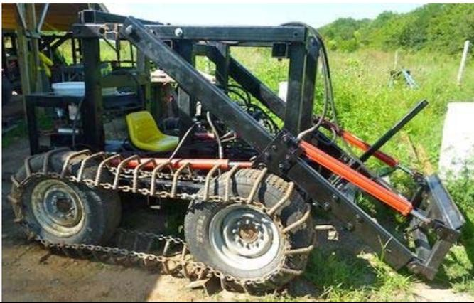
Aparentemente puede parecer un tractor sin demasiadas funcionalidades, pero es una máquina versátil y útil para la agricultura, construcción y otras tareas de servicios públicos.. Además, el agricultor puede reparar fácilmente cualquier avería y tiene un coste muy económico.
